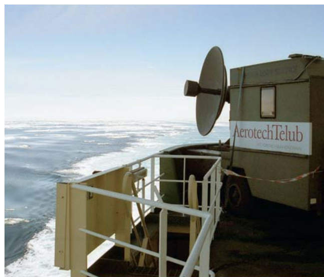
Fåglarnas flyttningaktivitet (hastighet, riktning och höjd) mellan Nya och Gamla världen observerades under expeditionen Beringia 2005 med hjälp av två målsökande radarstationer som var installerade på isbrytaren Oden.
