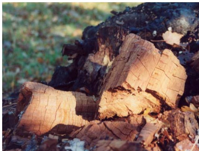
Vid brunröta lämnas lignin kvar i modifierad form och ger upphov till den bruna färgen.
