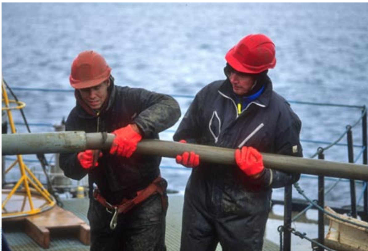
Ombord på isbrytaren Oden tar maringeologerna Martin Jakobsson och Jan Backman hand om en sedimentkärna tagen från Lomonosovryggen i Norra Ishavet. Foto: Magnus Elander
